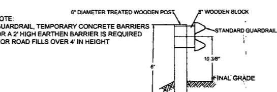
GUARDRAIL DETAIL N.T.S.
